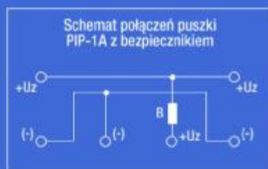
Schemat połączeń PIP-1A - bezw. 0,375 A
